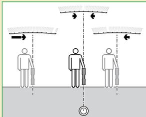
**Einsatz für:** Prüfung der groben Richtung der Zielleitungen als Teil des „Fegens“ vor der Ortung. Besser für dicht gepackte Bereiche als der Null-Modus allein.
