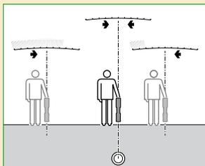
**Einsatz für:** Kennzeichnung einzelner Versorgungsleitungen auf langer Strecke in lose gepackten Bereichen. Akustische Signale lassen zu, dass Anwender sich eher auf den Audioton verlassen können, statt die Anzeige beobachten zu müssen.
