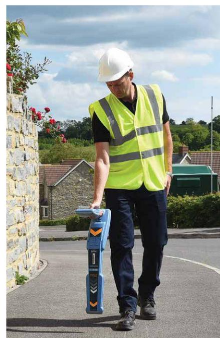
RD8100, unsere technisch ausgereifteste Reihe an Präzisionsempfängern, beruht auf diesem Vorbild an Leistung, Qualität und Zuverlässigkeit. Mit seiner einzigartigen Anordnung von fünf Antennen ermöglicht er Ihnen, die optimale Präzision für die jeweilige Aufgabe auszuwählen. Integriertes GPS und Datenerfassungsoptionen generieren automatisch Daten für Kundenberichte oder interne Qualitäts- und Sicherheitsprüfungen zur Förderung bester Arbeitspraktiken.
